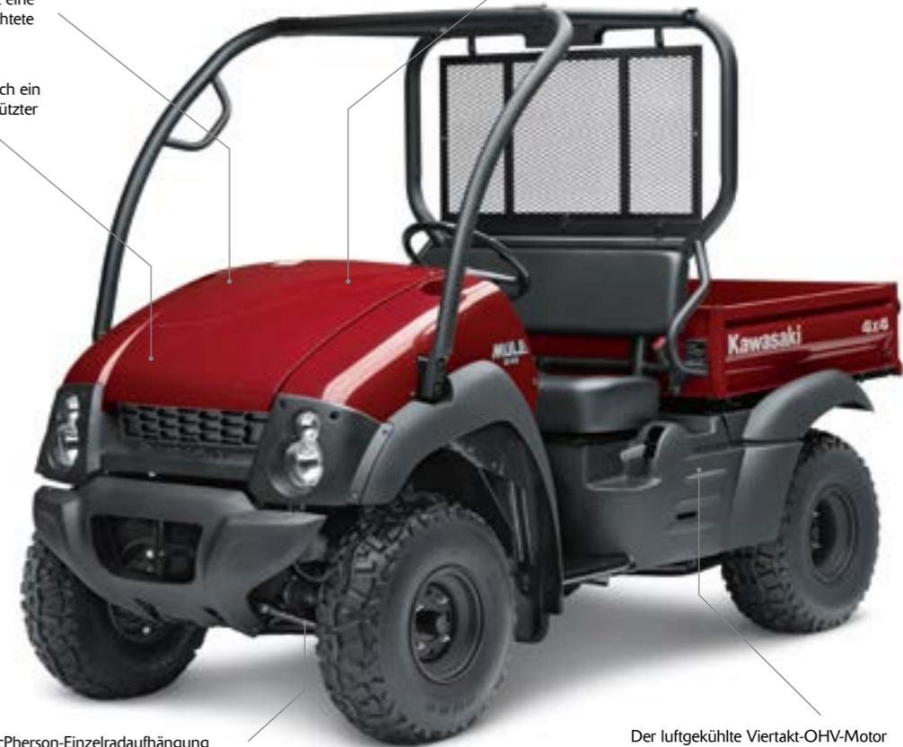
Durch die MacPherson-Einzelradaufhängung hat jedes Rad bei unebenem Untergrund Traktion und die Lenkung ist leichtgängiger
