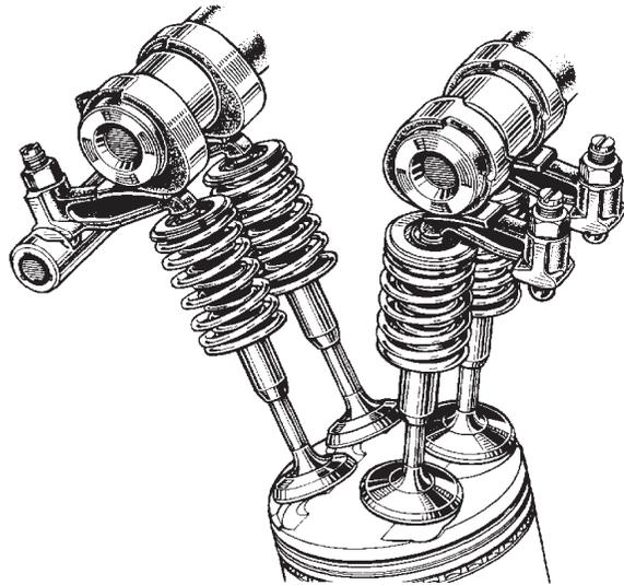
Durch die Füllung des Zylinders mit der größtmöglichen Kraftstoff-/Luft-Menge werden maximale Leistung und größtes Drehmoment erreicht. Dies kann durch Öffnen mehrerer großer Ventile erfolgen, über die Luft und Kraftstoff in den Zylinder gelangen. Fortschritte in der Metallurgie erlauben nunmehr die Verwendung sehr großer Ventilöffnungen mit äußerst dünnen (5,5 mm oder weniger im Durchmesser) und leichten Ventilschäften.
